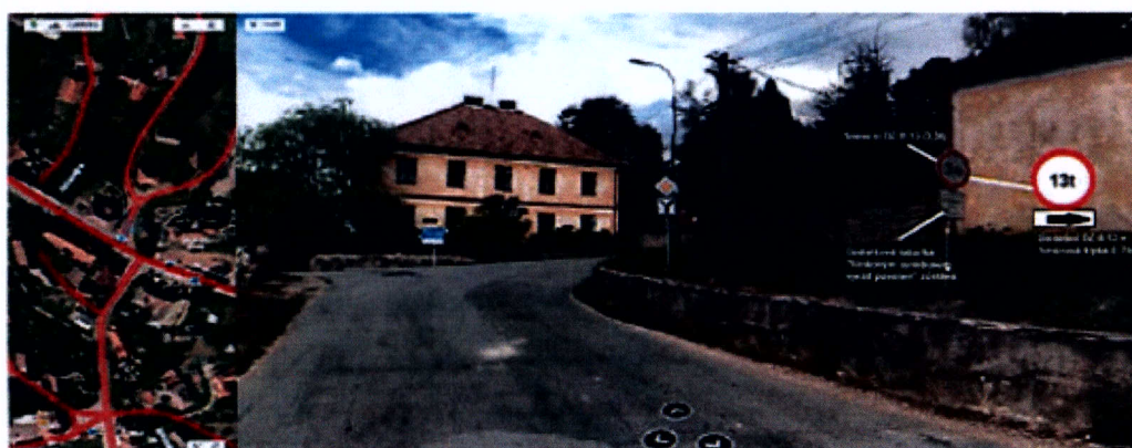
Snesení DZ B 13 (3,5t) Osazení DZ B 13 (13t) - směrová šipka E 7b Dodatková tabulka "linkovým autobusům vjezd povolen" zůstává na stejném místě.
